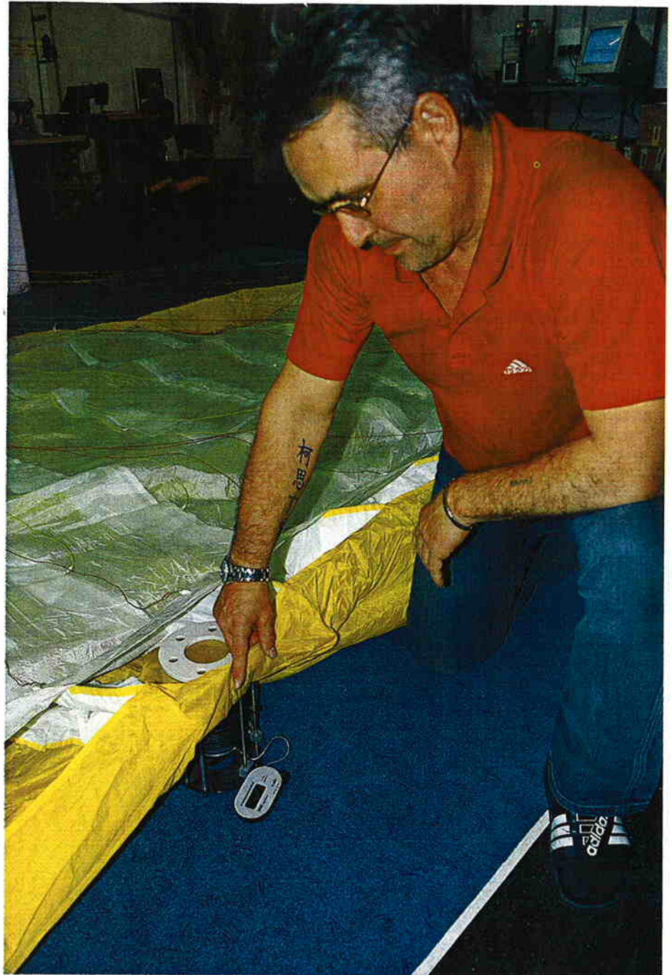
„Der Schirm ist k.o.“: Einer der drei „X-Acts“ fiel bei der Porositätsmessung durch.
