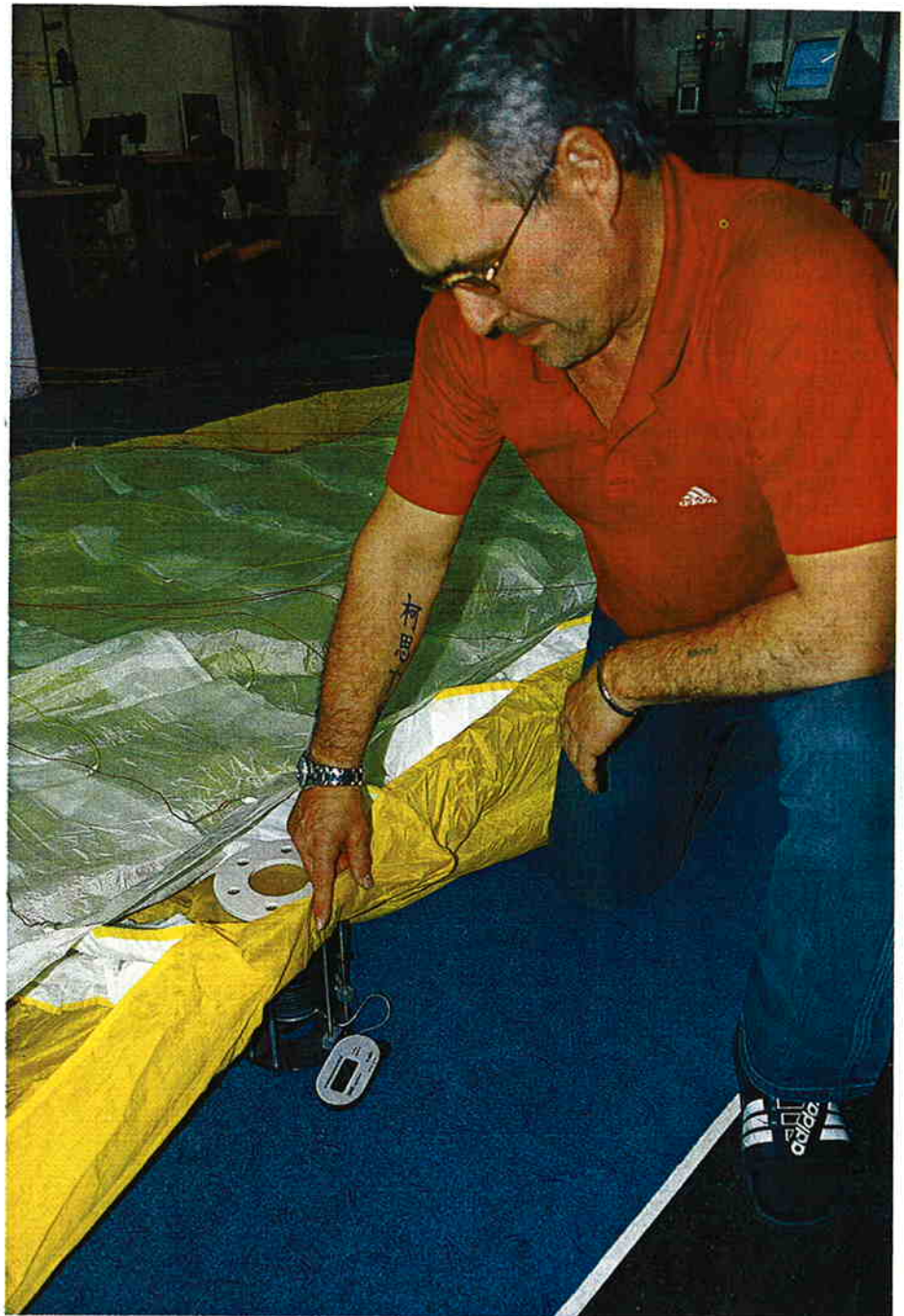
„Der Schirm ist k.o.“: Einer der drei „X-Acts“ fiel bei der Porositätsmessung durch.
